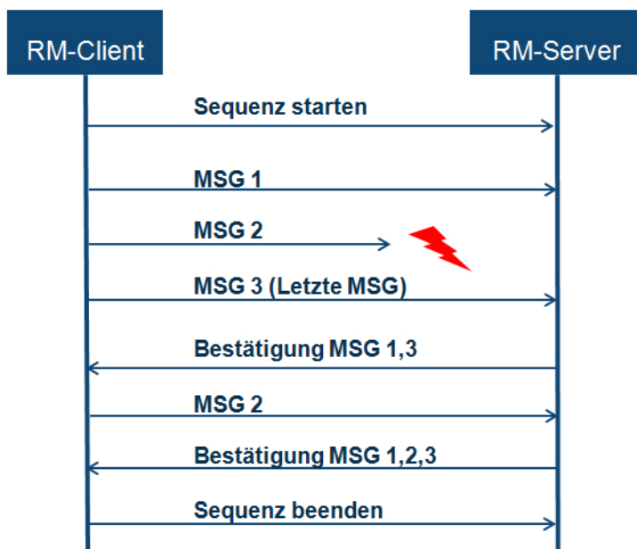
Abbildung 25 - RM-Nachrichtenfluss inklusive Übertragungswiederholung (sinngemäß übernommen aus [10])
